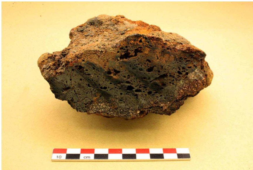
Figur 7. A 4457, PG 10021, Prov nr 3 i tvärsnitt. Grus- och sandkorn på undersidan visar att slaggstycket haft kontakt med ugsnbotten. Ränderna är märken från sågen från tvärsnittsingreppet på laboratoriet. Foto: GAL.
