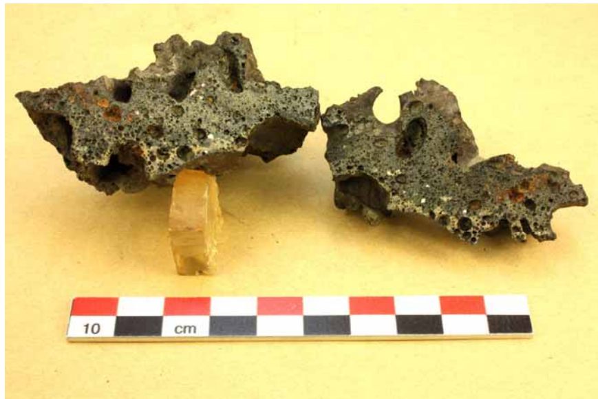
Figur 13. P 3445, PG 10008, Prov nr 7 i tvärsnitt. Mindre slaggstycke med tydliga kolavtryck runt om. Mot bottenfinns ett skikt av glasigt material. De silvriga vitare kornen i slaggen är små järndroppar. Foto: GAL.
