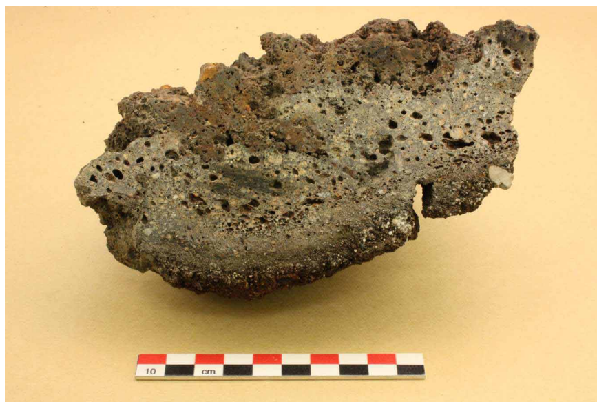
Figur 8. A 4457, PG 10021, Prov nr 4 i tvärsnitt. Lägg märke till de bruna partierna där slaggen fyllt i sprickor i ugnsväggen. Foto: GAL.
