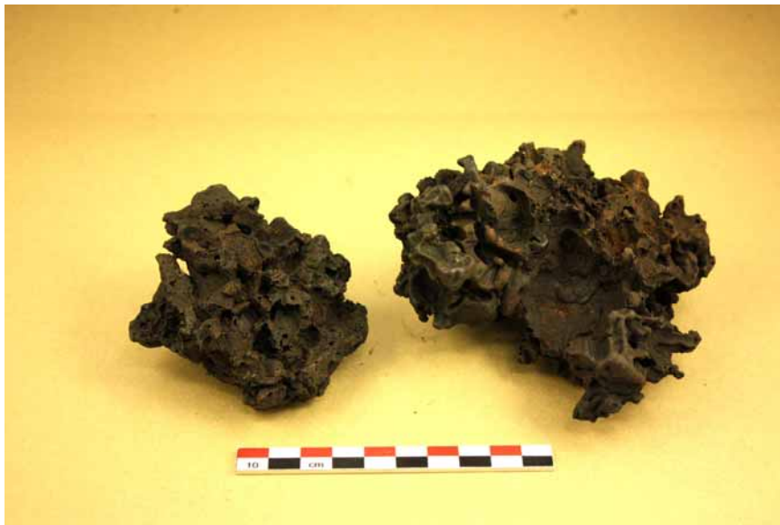
Figur 9. P 3665, Prov nr 5 (t.v.) och nr 6 (t.h.) innan tvärsnittsanalys. Stearinliknande slagg med avtryck av kol eller ved. Foto: GAL.
