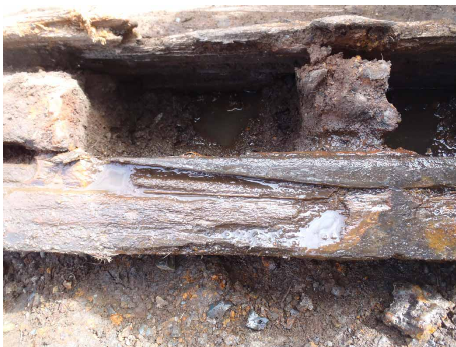
Bild 4. Spant och dubbel bordläggning. Här syns också skarven på den innersta bordläggningsplankan. Foto från norr.
