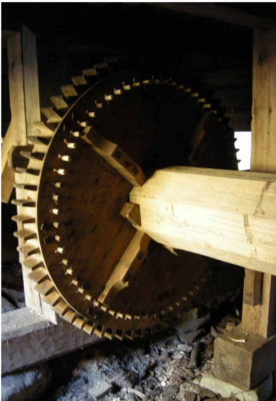
Figur 13. Kronhjulet och den norra delen av den utbytta axeln efter avslutad renovering. Foto från söder, Daniel Olsson, Länsmuseum Gävleborg 2012-09-21.
