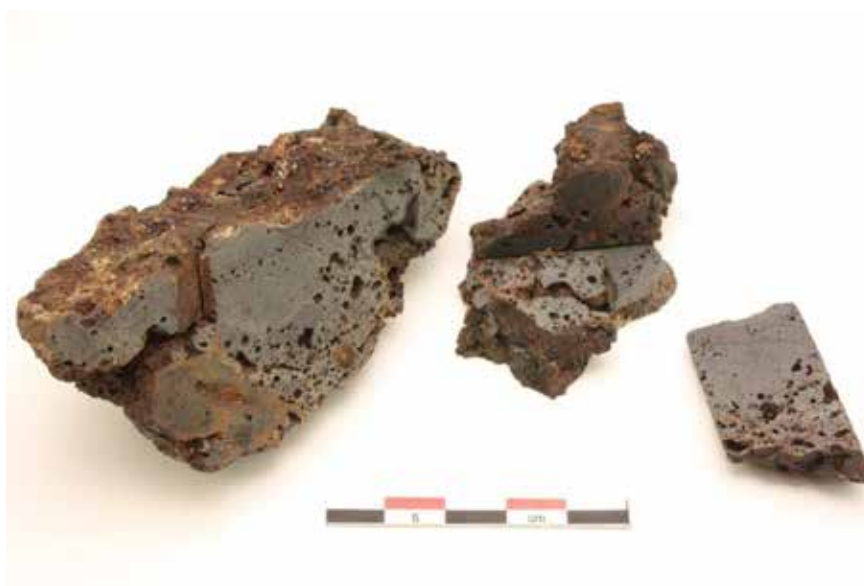
Figur 3. Det provtagna slaggstycket efter delning med såg. Delarna i mitten analyserades kemiskt medan den högra biten polerades till tunnslip. Observera den vänstra delens plana ovansida och konvexa undersida.
