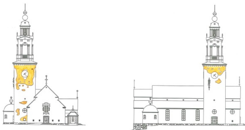
Figur 18. Skiss från Murtek över kvarvarande puts på tornets västra och norra sida.
