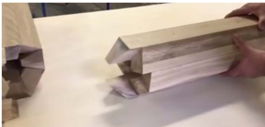
Figur 59. Sammanfogningen av de nya trädelarna till korset. Skärmdump från film som Lennartsson Snickeri har på sin Facebooksida.
