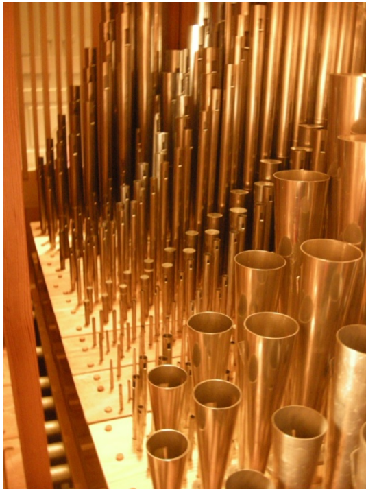
Figur 31. Detalj av pipor tillhörande olika stämmor i Setterquistorgeln. Foto: Daniel Olsson, Läns museet Gävleborg 2015-02-06.
