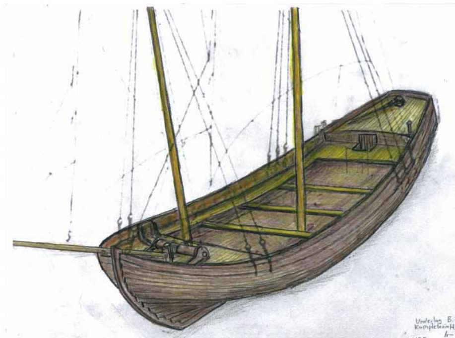
Bild 33. Rekonstruktionsritning av Engmanvraket. Harry Alopaeus modifierad efter grundteckning av Bertil Bonns (ur Högnäs och Örjans 1989).
