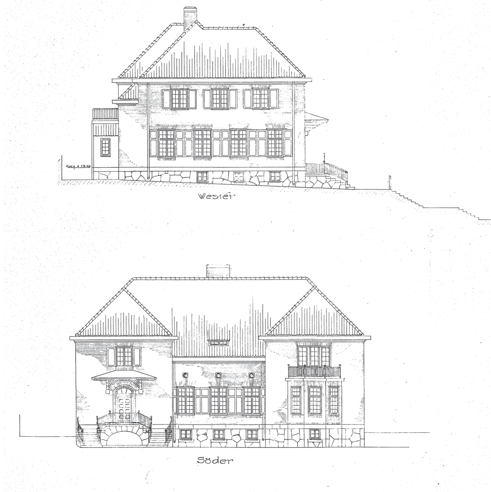
Figur 8. Variant på ursprungsritning från 1917 rörande den västra och södra fasaden. Förslaget innebär en mer detaljerad söderfasad med en organiskt formad entrétrappa med två trapplopp, tre hela fönsterbågar i byggnadens mitt och fasadutsmyckning med burspråk med ovanliggande balkong i den östra delen. Förslaget realiserades aldrig. Ritning från Kommunarkivet i Söderhamn.
