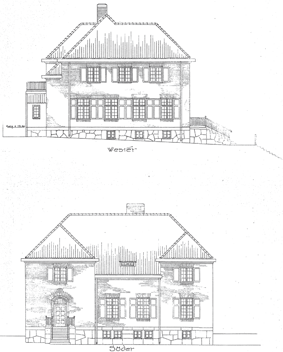
Figur 6. Ursprungsritning från 1917 rörande den västra och södra fasaden. Det är efter dessa ritningar som byggnaden uppförs. Huvudentrén mot söder markeras genom ett utdraget fasadparti och en hög trappa med ett rakt trapplopp. Mot norr skjuter partiet kring köksentrén ut genom den murade verandan med ovanliggande balkong. Notera den mycket låga takkupan i mittersta takfallet mot söder. Ritning från Kommunarkivet i Söderhamn.
