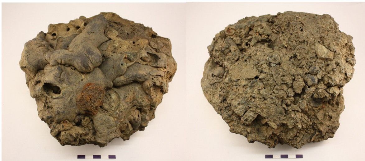
Figur 16. Till höger bottenslaggens ovansida med fler större slaggflöden. Till vänster undersida med flera små stearinformade slaggsträngar. Foto: Lena Grandin, GAL.
