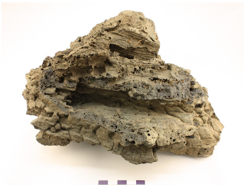
Figur 31. Exempel på vedavtryck i slagg. Foto: Lena Grandin, GAL.
