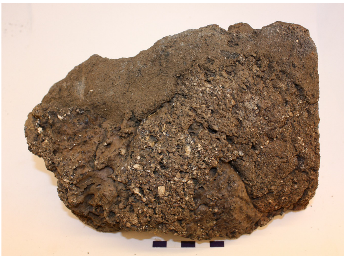
Figur 35. Prov K:535–6, ugnsvägg från utsidan. På den ursprungliga ugnsväggen av grov lera har ett lager av finare lera påförts. Foto: Ole Stilborg, SKEA.
