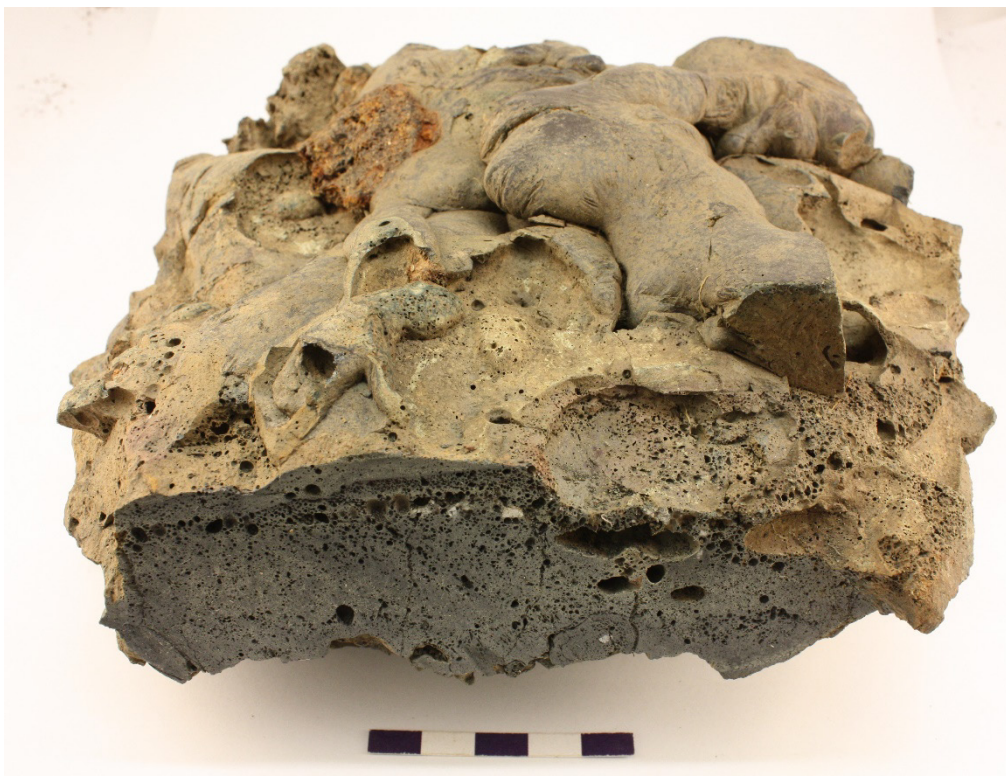
Figur 36. Prov S:535–6. Bottenslagg, delat tvärsnitt som visar en mestadels homogen uppbyggd slagg med en större slaggvolym. De små slaggsträngar som noterats på bottenytan kan urskiljas även i snittet. Nära överytan finns en tunn horisont av vita mineralkorn i anslutning till ett skikt med större porer; ovanpå detta finns ett tunt lager av de större slaggflöden som ses på överytan. Foto: Lena Grandin, GAL.
