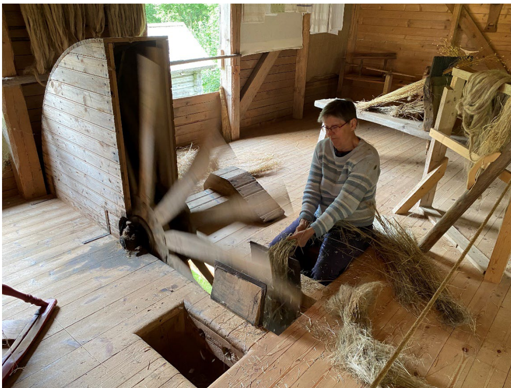
Figur 12. Vid slutbesiktningen kördes linskäktens maskineri och Kristina från Föreningen Trolldalen demonstrerade hur skäktningen av linet går till.
