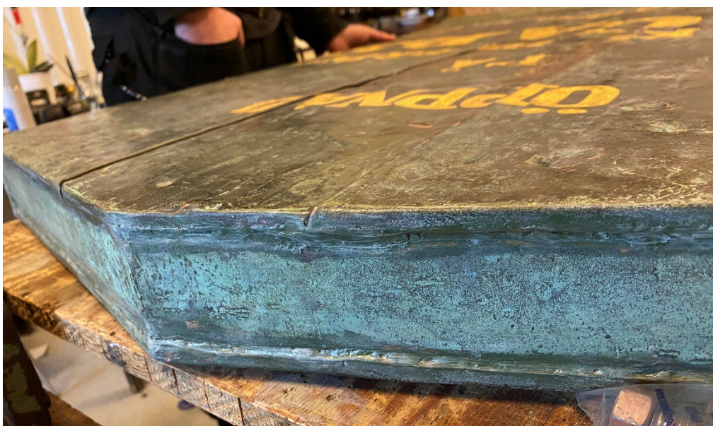
Figur 14. Isärsprucka falsar har lösts igen. Lagningarna har patinerats in i plåtens kulör. Foto: Ulrika Olsson, 2023-03-17.
