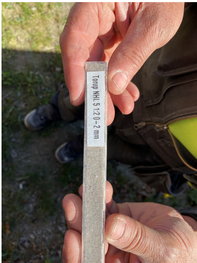
Figur 9. Beslut om fogens kulör. Torup från Målarkalk, NHL-bruk. Foto: Ulrika Olsson, 2023-05-11.
