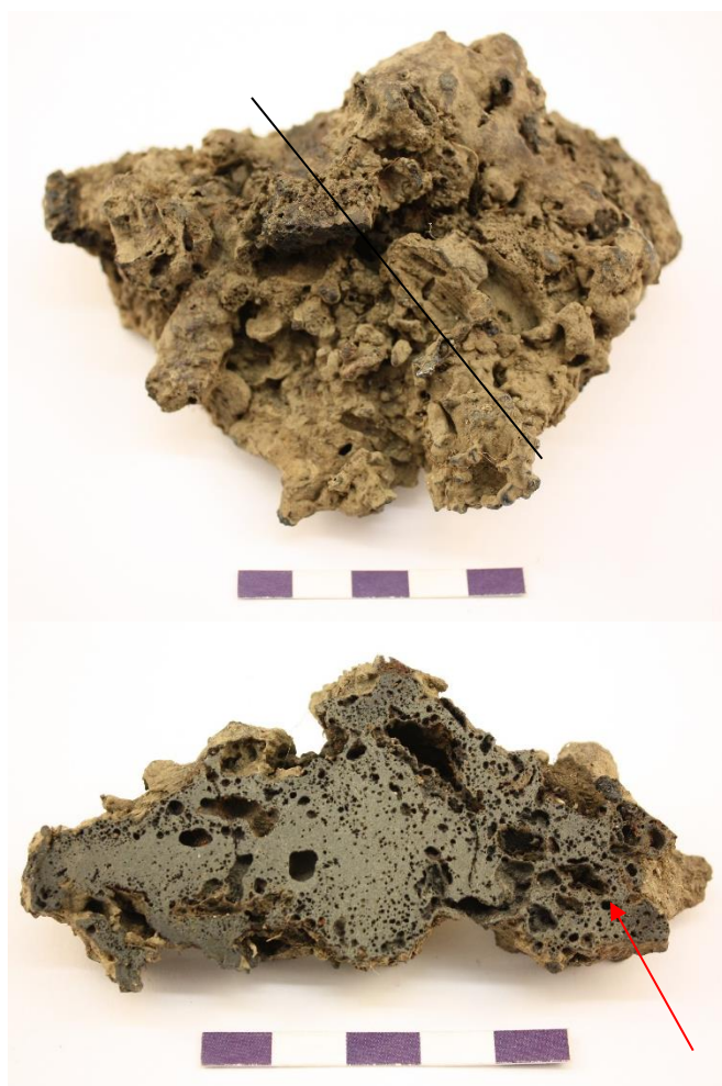
Figur 2. F 231 (2), en av slaggerna med små slaggsträngar och några kolavtryck. Den nedre bilden visar sågat tvärsnitt (längs linjen) med en homogent uppbyggd slagg och ett litet kolstycke nära ena kortsidan (vid pilen).
