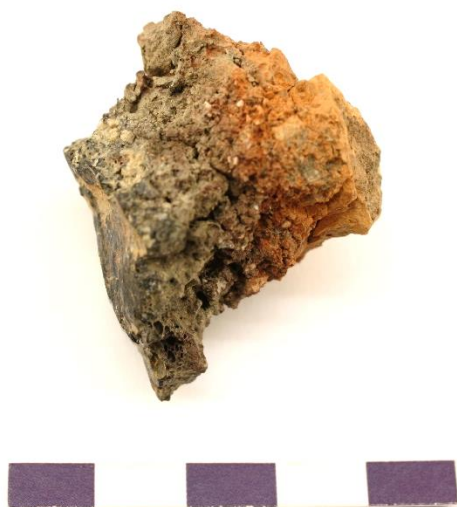
Figur 3. F 233 (2). Fragment av ugnsvägg med en profil som visar ökande värmepåverkan från den högra rödbrända delen (utsida) mot den vänstra, svarta och glasiga delen (insida) som har varit närmast värmekällan.
