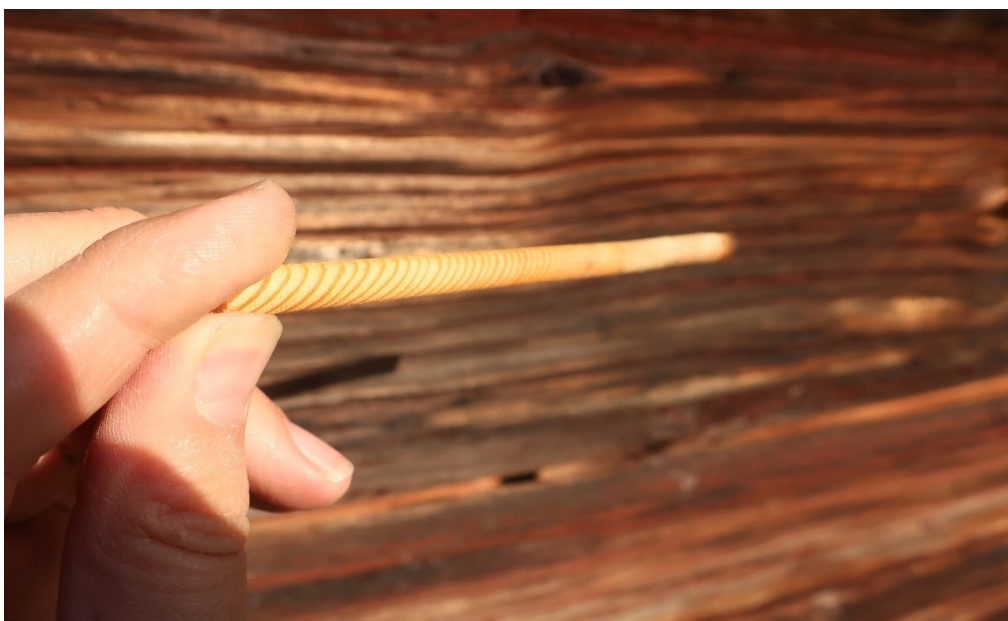
Figur 23. Detalj av borrprov mot bakgrund av den medeltida timmerstommen. Foto: Daniel Olsson 2021-10-07.
