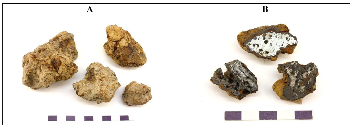
Figur 5. Prov 1. Urval av tyngre, rostiga, oregelbundna klumpar, delprov D. A: Hela bitar. B: De tre mindre i delat tvärsnitt med olika mängd metalliskt järn (ljus blänkande) i den mörkare slaggen. Överst: en större koncentration av metall, med en del hålrum, och omgivet av lite slag. Nere till vänster: små tunna sliror av järn i slag. Nere till höger: några få större koncentrationer av metall omgivna av slag.
