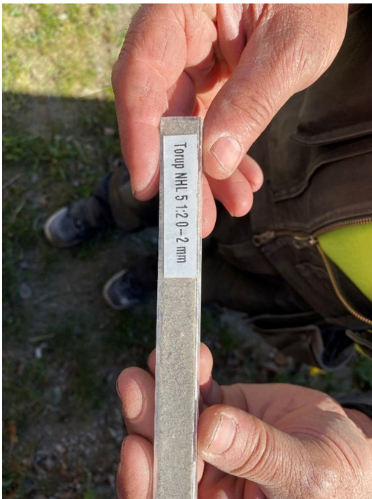
Figur 16. Beslut om fogens kulör fattades inför förra årets uppstart av murrenoveringen. Kulören som används är Torup från Målarkalk, NHL-bruk. Foto: Ulrika Olsson, 2023-05-11.
