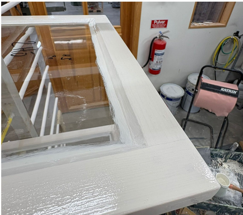
Figur 8. En av de nytillverkade fönsterbågarna med nytt glas under målning på Heinemanns verkstad. Foto: Heinemann Snickeri AB, oktober 2025.
