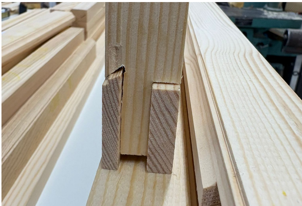
Figur 7. Detalj på sammanfogningen av bågstyckena. Foto: Heinemann Snickeri AB, oktober 2025.
